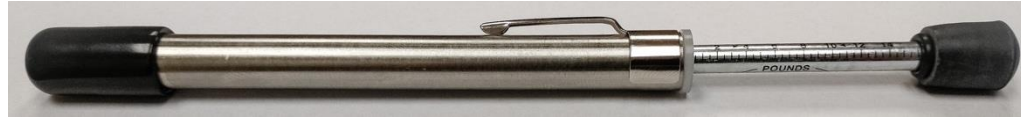
Fig XI.4 Herramienta típica para manómetro de puerta (consulte las instrucciones de uso del proveedor)
